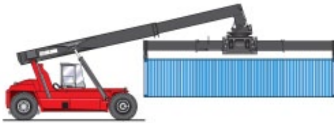
Los contenedores pueden elevarse longitudinalmente lo que permite transportar el contenedor a través de las puertas de un taller, las de un almacén de un puerto, etc., en posición baja.
